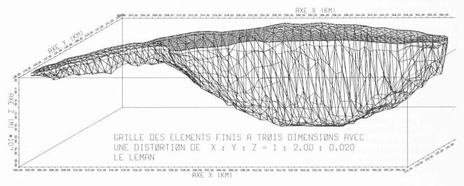
Fig. 1. — Grille à trois dimensions des éléments finis pour le Léman. (N. B. — Echelles distordues.)
