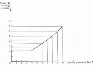
Fig. 3. — Temps de recharge en fonction de la distance parcourue.
