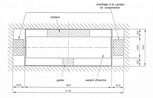
Fig. 1. — Implantation du volant d'inertie dans le volume disponible.
