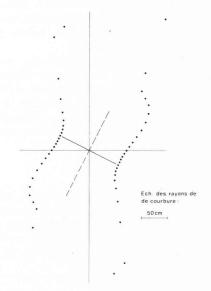
Fig. 4. — Indicatrice de Dupin au point P: valeur réelle r=66.5 cm; valeur calculée r=60.5 cm.
