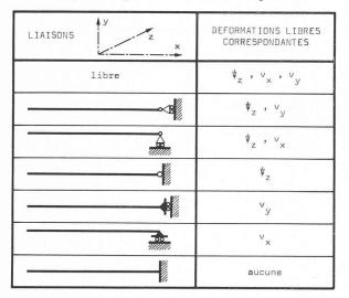
Fig. 10. — Types de liaisons externes considérés (x, y, z: système de référence global).
