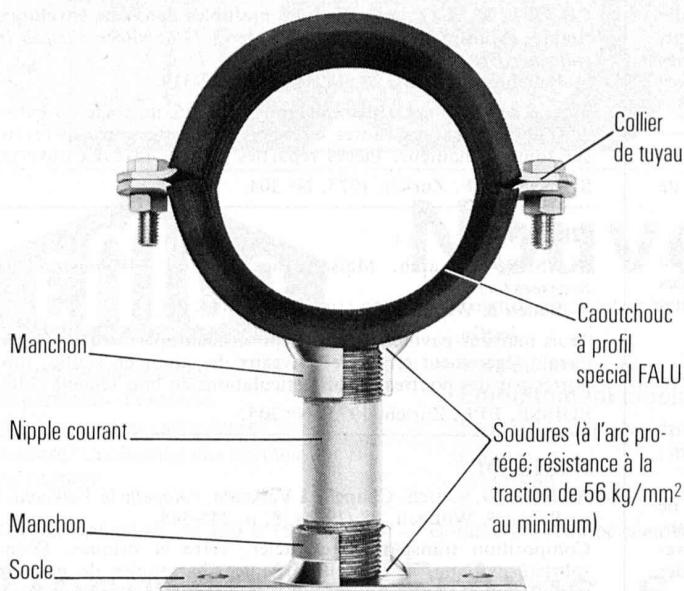
Grâce au soudage à l'arc protégé, nous amenons aux points de soudure un matériau de premier choix, d'une résistance à la traction de 56 kg/mm<sup>2</sup> au minimum. Les colliers de tuyau FALU supportent donc des charges très élevées.
