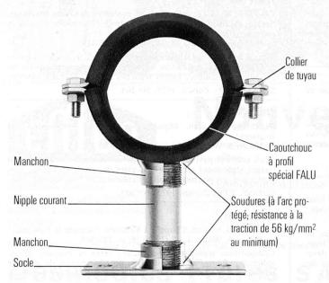
Grâce au soudage à l'arc protégé, nous amenons aux points de soudure un matériau de premier choix, d'une résistance à la traction de 56 kg/mm² au minimum. Les colliers de tuyau FALU supportent donc des charges très élevées.
