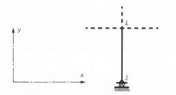
Fig. 4. — Cas particulier d'un appui libre de se déplacer selon
