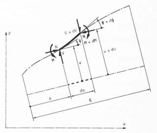
Fig. 3. — Equilibre d'un élément ds d'une barre.
