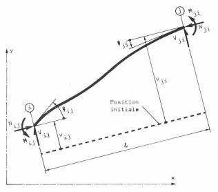
Fig. 2. — Déformée d'une barre du cadre.
