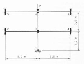
Barre 1-3 :  $I = 2000 \text{ cm}^4$ ,  $E = 2100 \text{ t/cm}^2$ .  $P_{cr} \text{ cadre} = 5215 \text{ t}$ .  $P_{cr} \text{ 3-1} = 461 \text{ t}$ . Barres 2-3, 3-4, 5-6, 6-7 et 3-6:  $I = 10\,000$  cm<sup>4</sup>,
