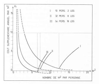
Fig. 2. — Coût moyen supplémentaire par m² de capteur en fonction de la surface de capteur (trois bâtiments théoriques).
