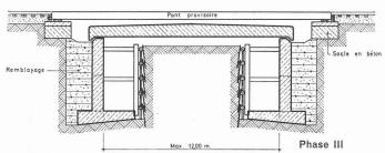
Fig. 183. — Construction de la dalle.
