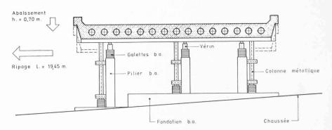
Fig. 188. — Passage inférieur de Malley: dispositif pour l'abaissement de la dalle (3 colonnes métalliques + 3 vérins de chaque côté de la chaussée).
