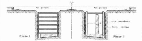
Fig. 182. — Phase I: fouilles exécutées en marche avant. — Phase II: construction des culées.
