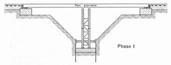
Fig. 184. — Construction d'une palée provisoire.
