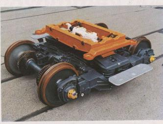
Fig. 161. — Bogie SIG type MQS avec le vérin hydraulique. (Photo SIG)
