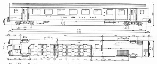
Fig. 138. — Dessin type de la voiture mixte à cinq compartiments de  $1^{re}$  classe et local à bagages. 29 places assises, tare 30 t.
