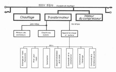
Fig. 156. — Schéma de principe de la fourniture d'énergie.
