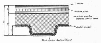
Fig. 144. — Détail C: constitution du plancher.
