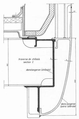
Fig. 140. — Détail A: liaison châssis-paroi latérale.
