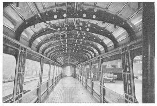
Fig. 143. — Intérieur du châssis-caisse nu.
