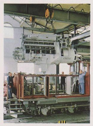
Fig. 126. — Démontage du groupe générateur d'une locomotive Em 3/3.
