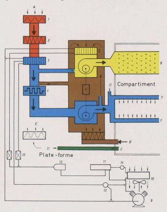
Fig. 157. — Disposition schématique de l'installation de climatisation.
