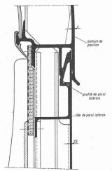
Fig. 142. — Détail B: liaison paroi latérale-pavillon.
