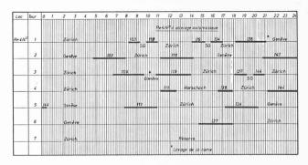
Fig. 166. — Roulement des locomotives.
