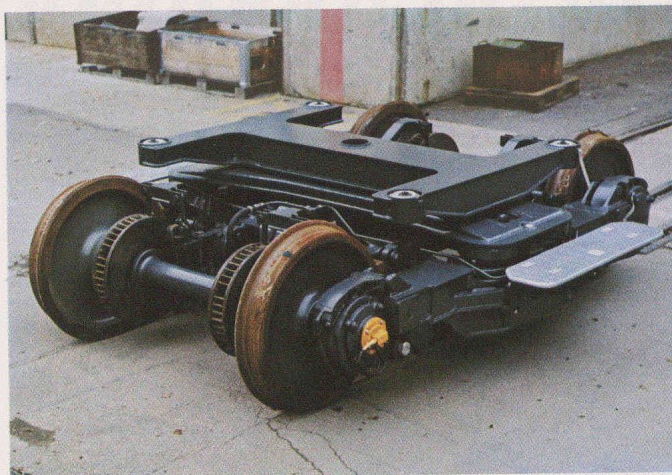
Fig. 158. — Bogie SIG type MQS. Empattement 2,35 m. Diamètre des roues 0,80 m. Poids 4700 kg. Flexibilité de la suspension primaire 1,7 mm/t, secondaire 13,1 mm/t, total = 14,8 mm/t. (Photo SIG)
