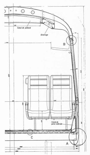
Fig. 139. — Demi-coupe transversale de la caisse (2e classe).
