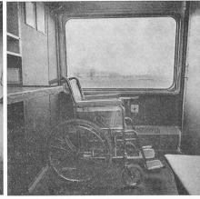
Fig. 155. — Compartiment pour invalide (Photo FFA).
