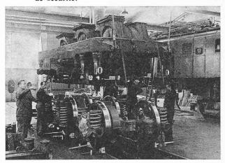
Fig. 125. — Montage d'un bogie de locomotive Ae 6/6.
