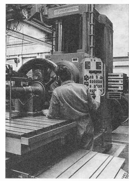
Fig. 132. — Aléseuse de précision avec visualisation sur les 3 axes.
