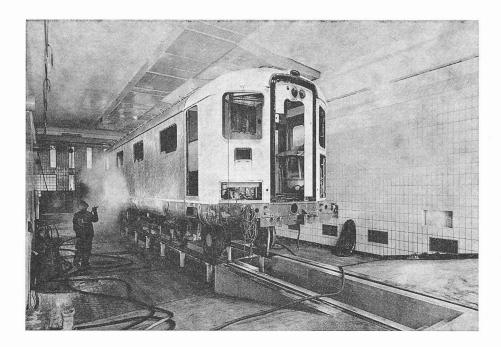
Fig. 130. — Local de giclage à haute pression.
