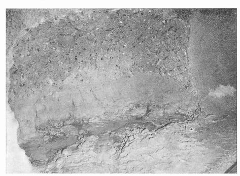
Fig. 9. — Lentille de sable saturé dans la moraine limoneuse rissienne (photo M. Odier).
