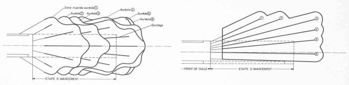
Fig. 10. — Schéma des sondages de reconnaissance et d'injection à l'avancement.
