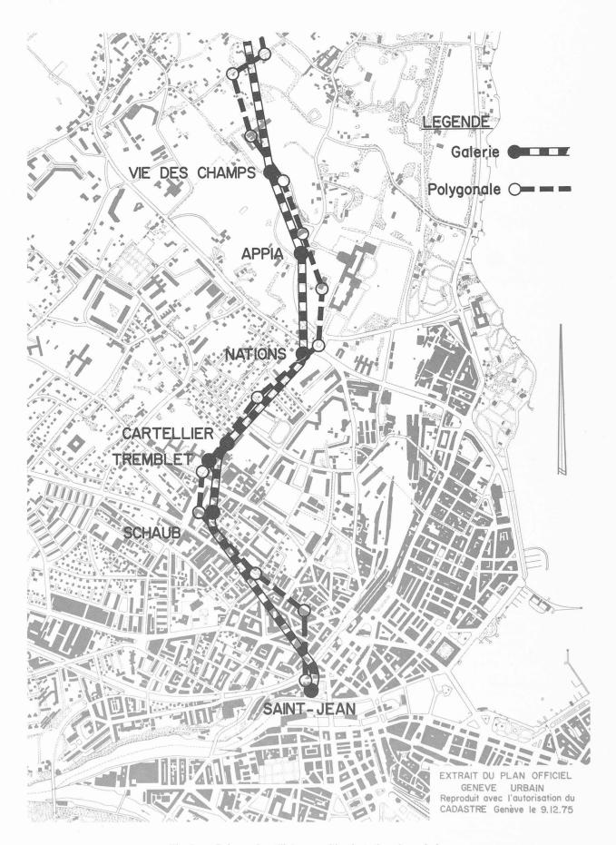
Fig. 3. — Polygonale utilisée pour l'implantation des galeries.
