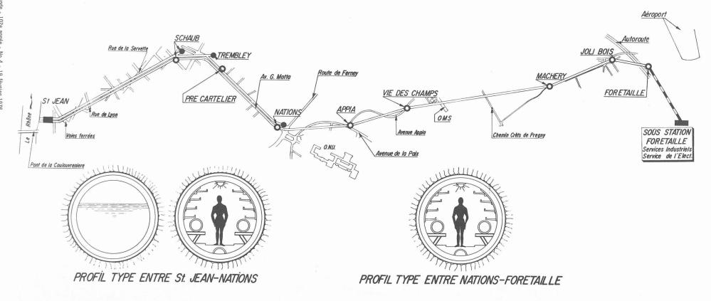
Fig. 1. — Tracé schématique et profils types des galeries.
