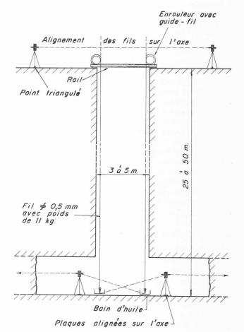
Fig. 4. — Schéma d'implantation des puits.
