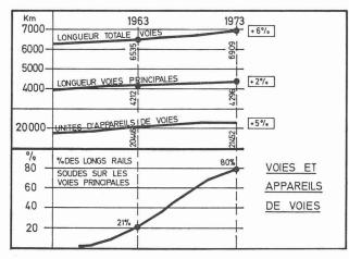
Fig. 111. — Longueur totale des voies CFF. Longueur des voies principales. Nombre d'unités d'appareils de voie. Evolution des voies sans joints.
