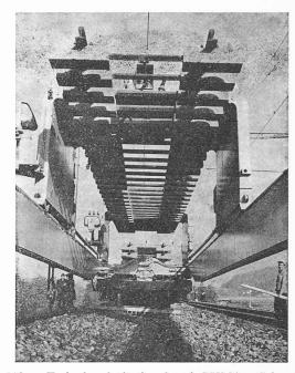
Fig. 118. — Train de substitution de voie PUMA — Scheuchzer.
