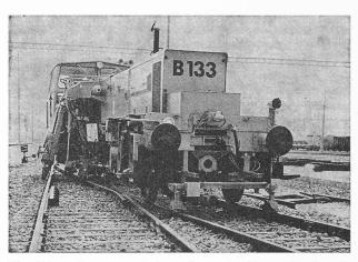
Fig. 119. — Bourreuse-niveleuse-dresseuse d'appareils de voie Matisa-B 133.
