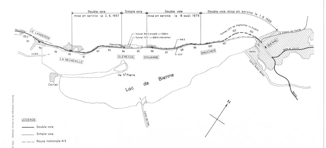
Fig. 109. — Etapes de construction de la double voie le long du lac de Bienne.
