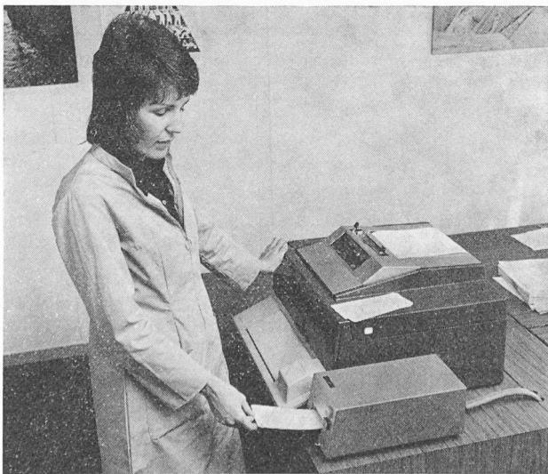
Fig. 77. — Réservation électronique des places : introduction de la carte de demande dans le lecteur de cartes, qui est en relation directe avec l'ordinateur central de Berne.
