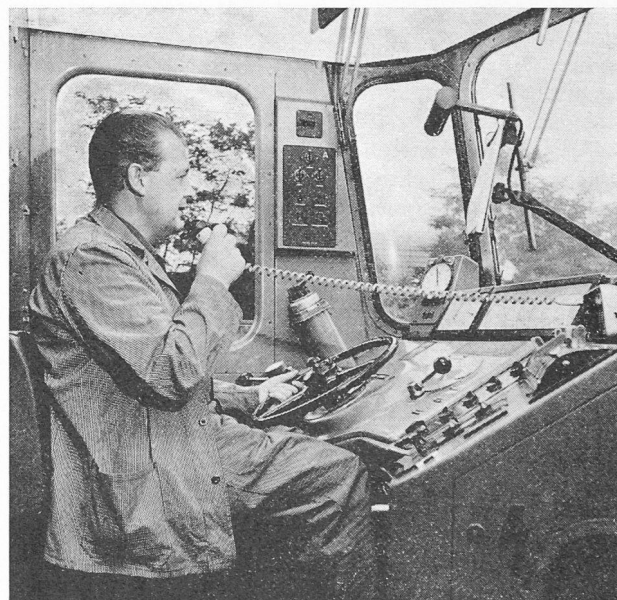
Fig. 80. — Liaison radio entre mécaniciens de locomotive et gares avoisinantes, en service sur la ligne du Saint-Gothard.
