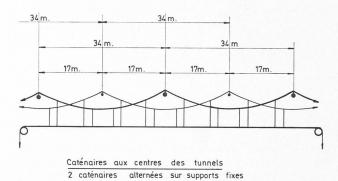
Fig. 65. — Schéma des caténaires du Simplon.
