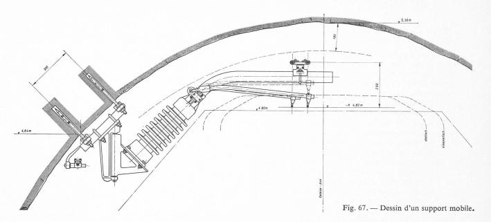
fils de contact sont dotés de systèmes de tendeurs. La construction de tendeurs implique l'introduction de contrepoids ou d'installations hydrauliques. Dans les deux cas, il faut construire des niches supplémentaires dans le rocher. Pour permettre la tension mécanique des câbles, des supports mobiles ont été scellés dans les parois du tunnel (fig. 67).
