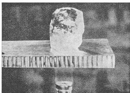
North American XB-70 : un panneau nid d'abeilles en acier brasé est soumis à la flamme d'un côté, sans que fonde le morceau de glace posé sur l'autre. (Photo North American.)
