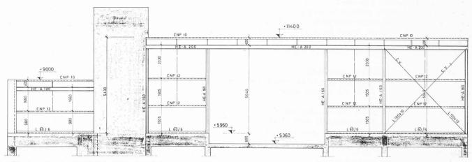
Fig. 3. — Station du Châble. Elévation de la façade est (sortie du télécabine), montrant la structure métallique de l'étage où sont implantées les installations techniques.
