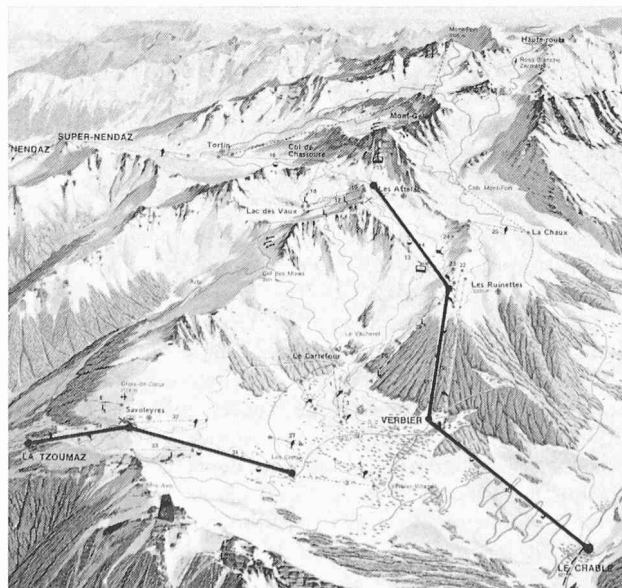
Fig. 4. — Remontées mécaniques dans la région de Verbier. En traits forts : télécabines utilisant le type de cabine standard.
