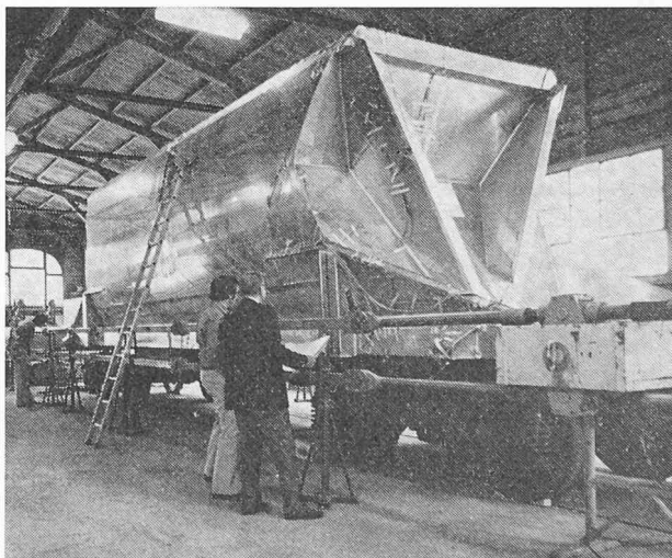
Fig. 2. — Le wagon phosphatier équipé pour les essais.
