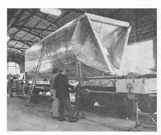
Fig. 2. — Le wagon phosphatier équipé pour les essais.
