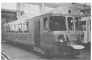
Fig. 8. — Rame destinée aux Chemins de fer fribourgeois (GFM), étroitement apparentée à la précédente, en cours de montage. On remarquera la porte frontale permettant l'accès aux voitures remorquées. (Photo SA des Ateliers de Sécheron.)
