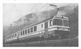
Fig. 7. — Nouvelle rame réversible ABDe 4/8 du Montreux-Oberland bernois, récemment mise en service. (Photo SA des Ateliers de Sécheron.)
