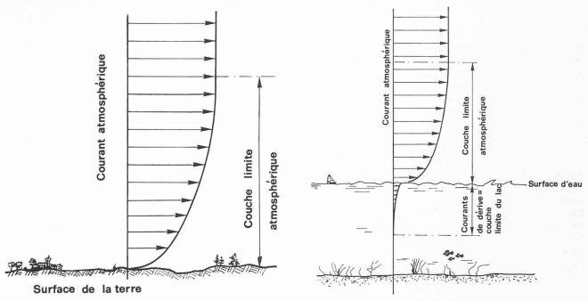
Fig. 1. — Couche limite atmosphérique sur le sol (à gauche) et sur l'eau (à droite).
