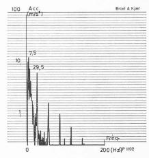
Fig. 3. — Spectre des vibrations dans l'axe de la machine. Machine travaillant horizontalement.
