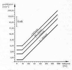
Fig. 1. — Vibrations transmises par les mains aux membres supérieurs. Limites d'exposition en fonction du temps d'exposition et de la fréquence (mesure en 1/3 d'octave).
