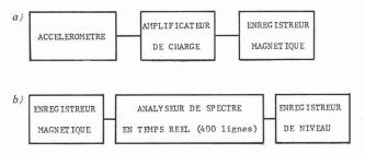
Fig. 2. — a) Schéma de mesure. b) Schéma de dépouillement.
