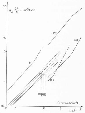
Fig. 11. — Comparaison de l'efficacité combinée de divers remplissages.
