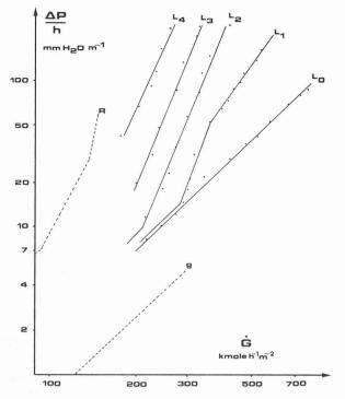
Fig. 9. — Pertes de charge du remplissage PP.
