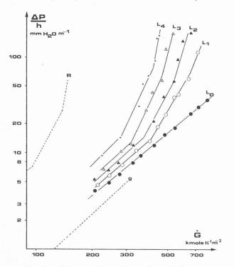
Fig. 7. — Pertes de charge du remplissage MP.
