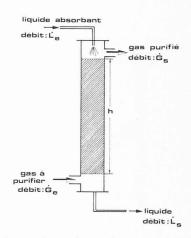
Fig. 1. — Schéma d'une colonne d'absorption.
