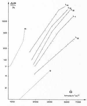
Fig. 8. — Pertes de charge du remplissage PT.
