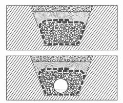
Fig. 12. — Les nappes non tissées permettent la réalisation de drains efficace, car elles autorisent de grandes sections, régularisent l'écoulement et évitent le colmatage.
