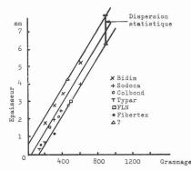
Fig. 4. — Relation entre l'épaisseur et le grammage de nappes non tissées PP et PES.
