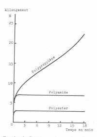
Fig. 2. — Courbe de fluage au niveau des filaments. Les courbes sont obtenues en soumettant un filament de polymère à une contrainte constante équivalente à 20 % de sa charge de rupture. On note les déformations enregistrées dans le temps. Le polyester et le polyamide arrivent rapidement à la stabilité, pour, finalement, atteindre après un temps suffisamment long la rupture.
