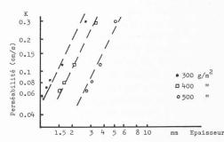
Fig. 8. — Perméabilité K en fonction de l'épaisseur de nappes non tissées PES.
