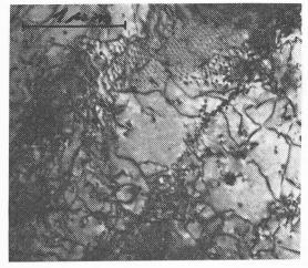
Fig. 1. — Répartition des dislocations dans un alliage déformé
