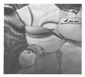
Fig. 4. — Germes de recristallisation par coalescence de sous-grains.
