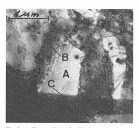
Fig. 3. — Germes de recristallisation par croissance de sous-grains.
