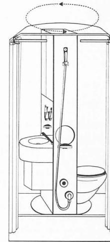
Une surface de 2 m<sup>2</sup> est suffisante pour l'installation de la cabine « BB », livrée en éléments préfabriqués. Lavabo, douche et toilette sont montés sur une colonne tournante. Sa manutention n'offre aucune difficulté. L'élément désiré mis en place est prêt à l'emploi sans que l'utilisateur se trouve à l'étroit ou qu'il renonce au confort et au bien-être.
