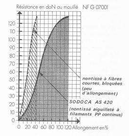
Fig. 1. — Diagramme d'allongement de deux types de non-tissés.
