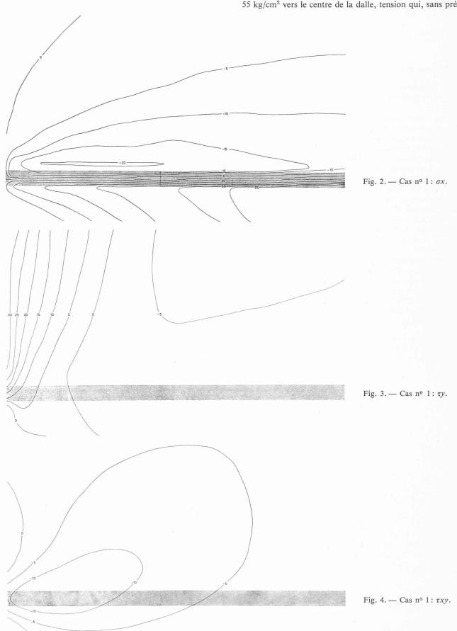
caution spéciale, provoque certainement une fissuration importante du balcon. Il faut remarquer que l'effort est maximal à la naissance du balcon et diminue vers le bord
