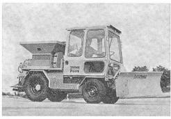
Le Pony Boschung équipé d'un chasse-neige et d'un distributeur de produit de dégel.
