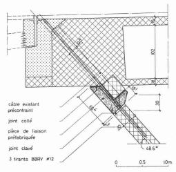
Fig. 2. — Détail de la liaison d'une béquille extérieure.
