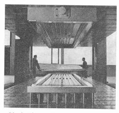
Fig. 3. — L'emboutissage à froid permet d'obtenir des éléments précis, à partir de tôle d'aluminium, d'acier ou d'inox.
