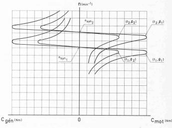
Fig. 195. — Caractéristique couple-vitesse d'un moteur asynchrone.
