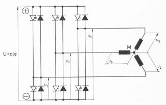
Fig. 202. — Schéma d'un onduleur triphasé à pulsation simple.
