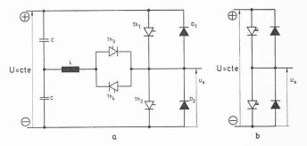
Fig. 201. — Schéma du commutateur électronique.
