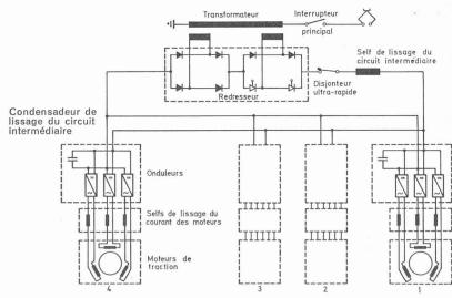
Fig. 212. — Schéma des circuits principaux de la locomotive Be 4/4 12001.
