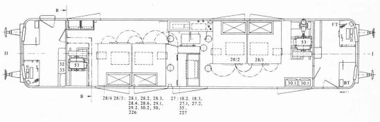
Fig. 214. — Disposition de l'équipement électrique de la locomotive Be 4/4 12001.
