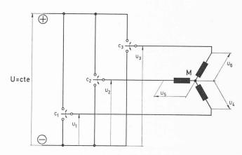
Fig. 199. — Principe de fonctionnement d'un onduleur triphasé. C<sub>1-3</sub> commutateurs M moteur triphasé
