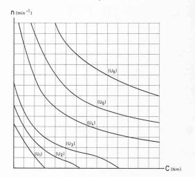
Fig. 194. — Caractéristique couple-vitesse d'un moteur à excitation série.
