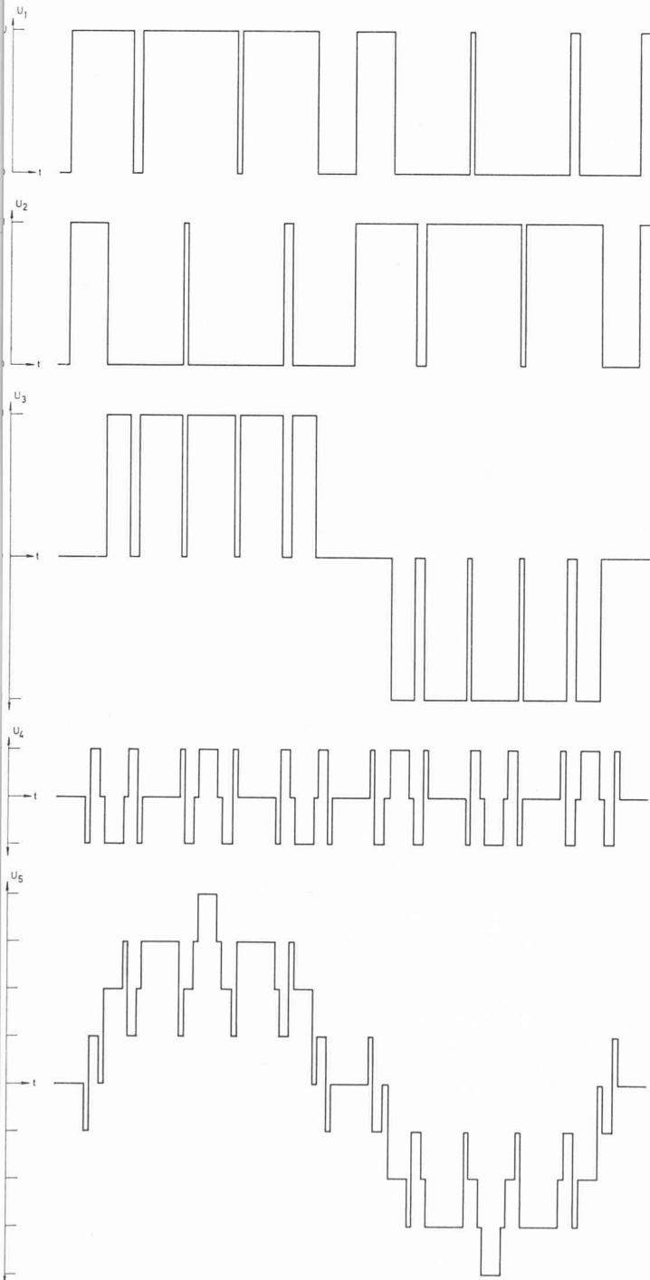
Fig. 204. — Séquences des tensions d'une phase d'un onduleur triphasé à double pulsation dans le procédé de la sous-oscillation.
