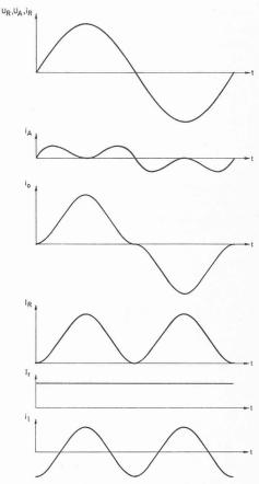
Fig. 208. — Allure des tensions et courants du redresseur pulsant « 2 quadrants » dans l'hypothèse d'une self d'entrée nulle et d'une fréquence de hâchage infinie.
