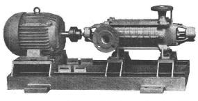
Δ Pompe à haute pression, type MB, (construction à segments).
