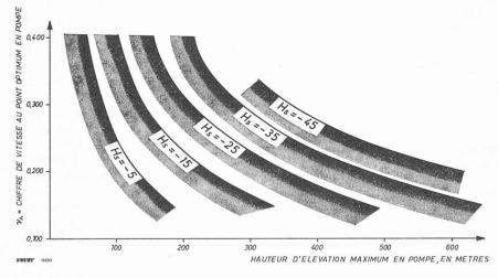
Fig. 10. — Pompes-turbines réversibles à un étage: profondeurs d'enfoncement approximatives en fonction de la hauteur d'élévation H et du chiffre de rotation ou de vitesse  $\nu_{\Lambda}$  (facteur de forme). Ce diagramme suppose des variations de chute modérées.
