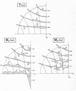
Fig. 8. — Moment de torsion et moments fléchissants engendrés dans les barres de la coupole sphérique de la figure 5 par une force isolée P=10 t, appliquée au sommet. L'axe principal  $y^*$  des sections est horizontal  $(\varphi=0)$ .
