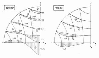
Fig. 6. — Déplacements globaux  $\nu$  (selon y) et w (selon z) engendrés par une force verticale P=10 t, appliquée au sommet de la coupole sphérique de la figure 5.
