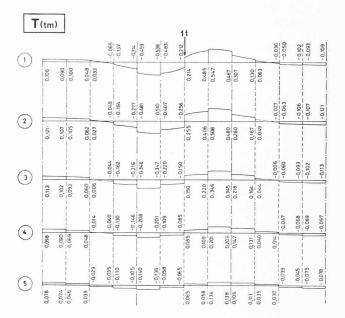
Fig. 11. — Diagrammes des moments de torsion dans les poutres maîtresses du pont courbe de la figure 9.
