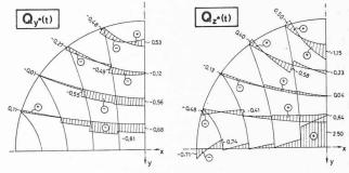
Fig. 7. — Effort normal et efforts tranchants engendrés dans les barres de la coupole sphérique de la figure 5 par une force isolée P=10 t, appliquée au sommet. L'axe principal  $y^*$  des sections est horizontal  $(\varphi=0)$ .
