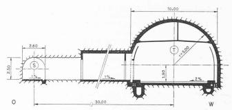
Coupe transversale du tunnel (T) et de la galerie de sécurité (S) (vue prise dans la direction du sud).
