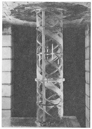
Fig. 16. — Modèle en plexiglas d'un puits hélicoïdal. Débit : 0,5 m³/s. (Photo Laboratoire de recherches hydrauliques et de mécanique des sols, EPF Zurich.)
