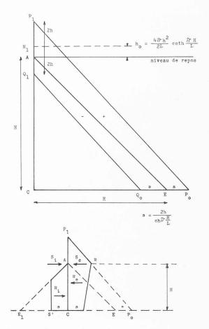
Fig. 1. — Diagramme de pression sur un obstacle vertical.
