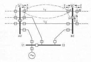
Fig. 4. — Protection de réserve centralisée.
