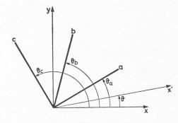
Fig. 5. — Position de trois jauges a, b et c par rapport à l'axe x.
