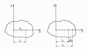
Fig. 1. — Déplacement d'une longueur  $l_{\it o}$  lors de la déformation d'un corps.
