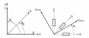
Fig. 6. — Position des jauges sur une rosette rectangulaire.
