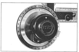
La tête à dessiner Isis a un levier de débrayage. On l'actionne avec le **pouce**, ce qui garantit une grande sécurité de fonctionnement. On peut choisir à volonté l'angle de départ des règles. C'est le point zéro, avec cran d'arrêt, que l'on retrouve automatiquement tout au long du travail.
