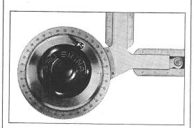
La tête à dessiner Pro Signa a un bouton de débrayage, que l'on actionne avec la **paume de la main.** Ainsi, la position de la main est indépendante de l'angle des règles.
