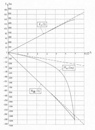
Fig. 19. — Variation de l'effort normal, du moment fléchissant et de la réaction horizontale gauche de l'arc de la figure 16a en fonction de l'intensité de la charge. Les diagrammes en traitillé représentent les résultats selon la théorie du 1er ordre.
