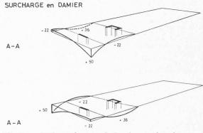
Fig. 8. — Déformations verticales du premier niveau sous les surcharges dissymétriques et les effets thermiques.
