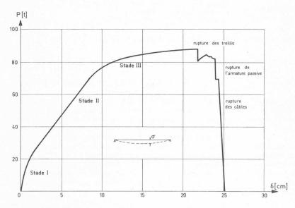
Fig. 18. — Enregistrement de la flèche sous un vérin pendant l'essai de rupture.
