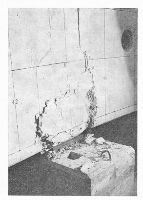
Fig. 10. — Ecrasement de la zone comprimée sur appui.
