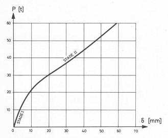
Fig. 13. — Enregistrement de la flèche sous un vérin pour la mise en charge à  $P=60~\rm t.$
