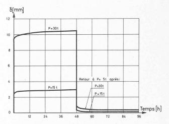
Fig. 15. — Evolution de la flèche médiane en fonction du temps.
