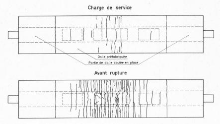
Fig. 9. — Fissuration de la dalle sur appui
