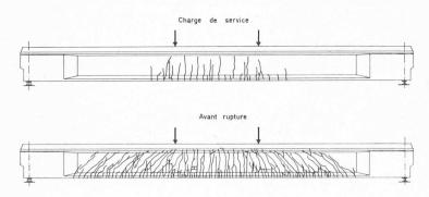
Fig. 14. — Fissuration de la poutre.
