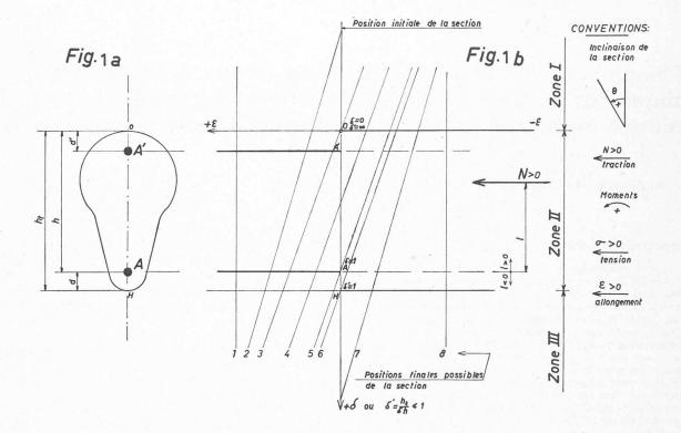
pression), à une distance l du centre de gravité des aciers A. On conviendra de donner au moment (Nl) le signe positif s'il fait tourner la section dans le sens trigonométrique.
