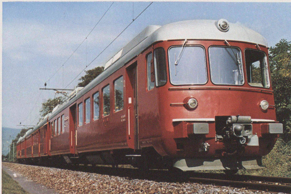
Fig. 32. — Rame de banlieue Bo'Bo'Bo'Bo'Bo'Bo' de la série RABDe 12/12 des CFF.
