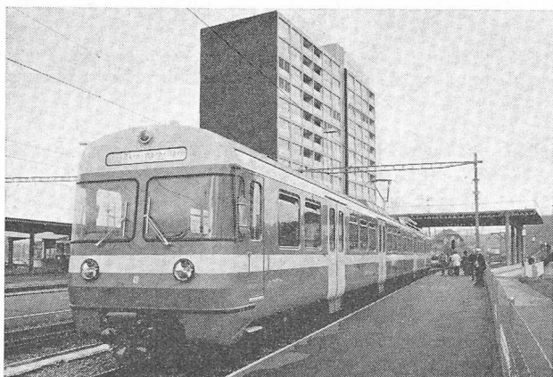
Fig. 35. — Rame de banlieue à courant continu Bo'Bo' + 2'2' de la série Be 4/8 des Chemins de fer Soleure-Zollikofen-Berne (SZB) et Berne-Worb (VBW) ; voie métrique. 136 places assises ; longueur 40 m, hauteur du plancher 950 mm, poids en charge env. 70 t ; puissance unihoraire 427 ch, vitesse max. 75 km/h.
