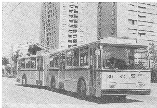
Fig. 36. — Trolleybus articulé unifié à hacheur. Longueur 18 m, largeur 2,5 m ; 160 passagers ; poids en charge 27 t, vitesse max. 60 km/h. Un véhicule de cette série a circulé pour démonstration aux USA et au Canada.
